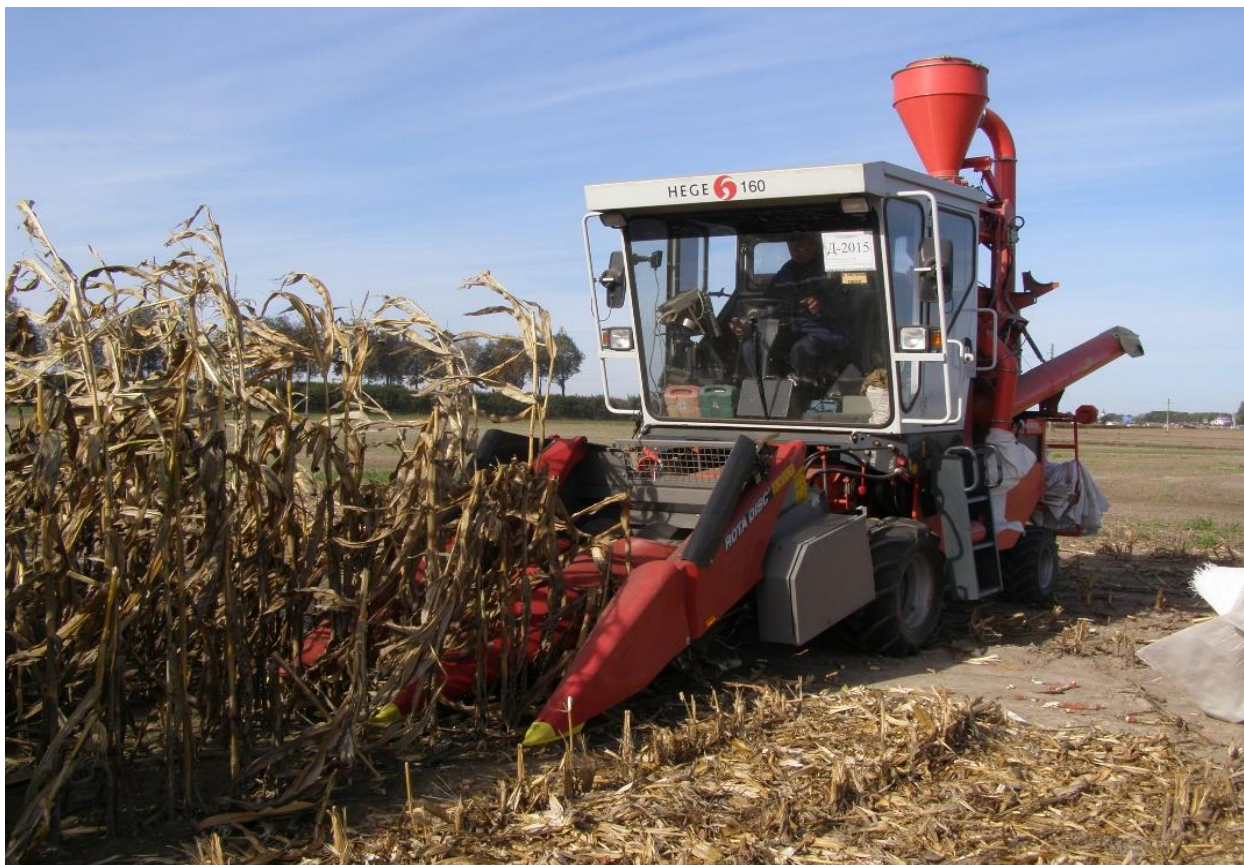
Рис.4. Малогабаритный зерноуборочный комбайн «Неге 160» с модульной системой замены жатки с зернового типа на кукурузный тип, ГСХУ «Октябрьская сортоиспытательная станция»
