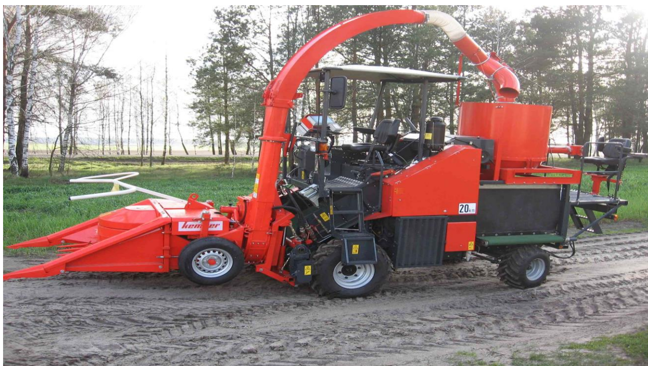
Рис.3. Малогабаритный селекционный кормоуборочный комбайн «Sibus» («Hege 212») с электронными весами для уборки трав, кукурузы на силос, ГСХУ «Мозырская сортоиспытательная станция»
